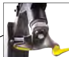
Protections clipsées pour échange rapide
