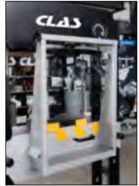
Plexiglass protégeant l'opérateur
