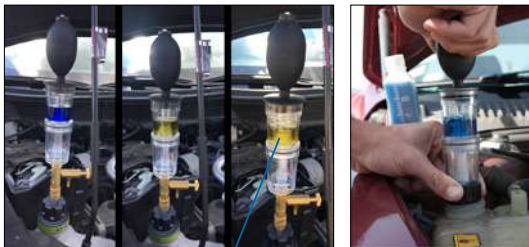
Liquide jaune = joint de culasse HS
