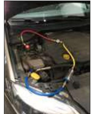
Ce kit permet de contrôler visuellement l'état du circuit de climatisation.
