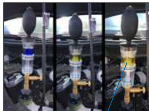
Liquide jaune = joint de culasse HS
