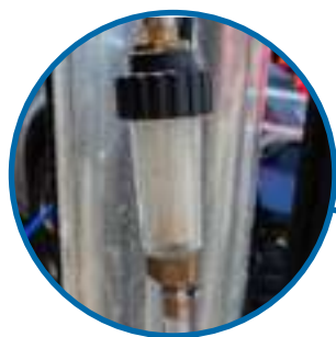
Ajout d'un filtre pour éviter l'encrassement de la cuve de liquide usagé
