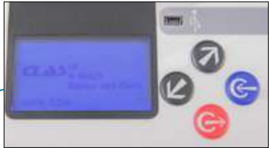
Écran graphique LCD 128x64 pixels Manipulation simple et intuitive
