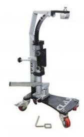
Item name PACK BRAKE CALIPER SUPPORT + BRAKE DRUMS SUPPORT
