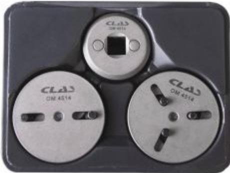
**Artikelbezeichnung** 3 VERSTELLBARE BREMSSATTELAUFWICKELADAPTER 2-3 STIFT
