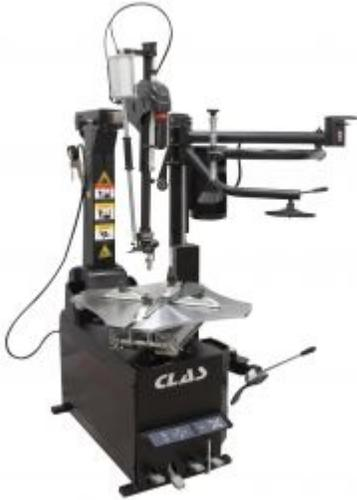
**Artikelbezeichnung** REIFENMONTIERMASCHINE MIT HEBELLOSER 13-28" 2-GANG-SYSTEM 400V
