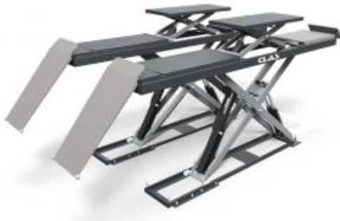
**Artikelbezeichnung** PONT CISEAUX EXTRA PLAT 5.5T LEVAGE AUXILIAIRE 230V 5.5T
