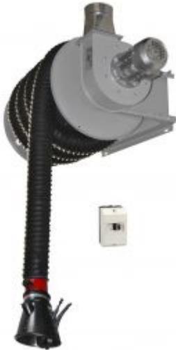
**Artikelbezeichnung** Abgasabsaugung auf Motorrad-Rolle 10m Ø75mm
